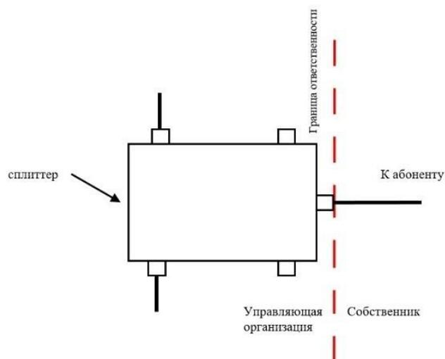
Кабельные линии от сплиттера до квартиры, обслуживаются Собственником. Сплиттер, расположенный в коммуникационной шахте и кабельные линии от него обслуживает Управляющая организация.
