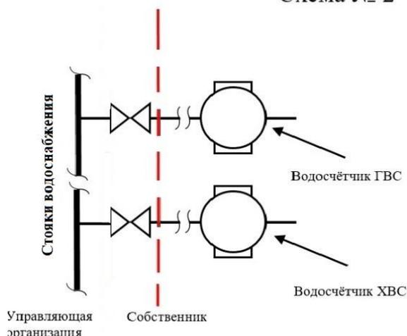
Внутриквартирные стояки водоснабжения, первую запорную арматуру обслуживает Управляющая организация.
