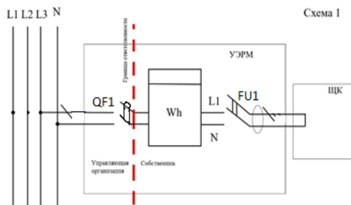
Счетчик электрической энергии Wh и устройство защитного отключения FU1, расположенные в этажном шкафу УЭРМ, отходящие от этажного шкафа электросети и всё электрооборудование внутри помещения, обслуживает Собственник помещений.
