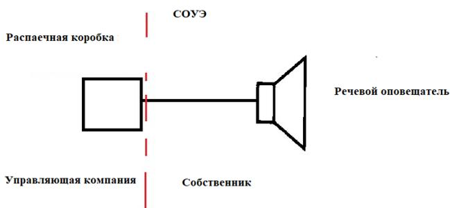
Кабельные линии от распаечной коробки до квартиры, речевой оповещатель, обслуживаются, Собственником. Распаечную коробку, расположенную в запотолочном пространстве приквартирного холла и кабельные линии от неё до стойки оповещения обслуживает Управляющая организация.
