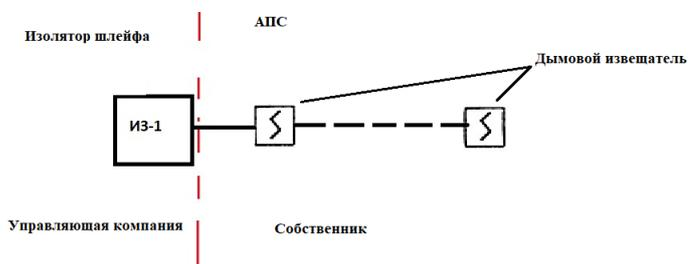
Кабельные линии от изолятора ИЗ-1 до квартиры, дымовые извещатели обслуживаются Собственником. Изолятор ИЗ-1, в запотолочном пространстве приквартирного холла и кабельные линии от него до прибора ПКП обслуживает Управляющая организация.
