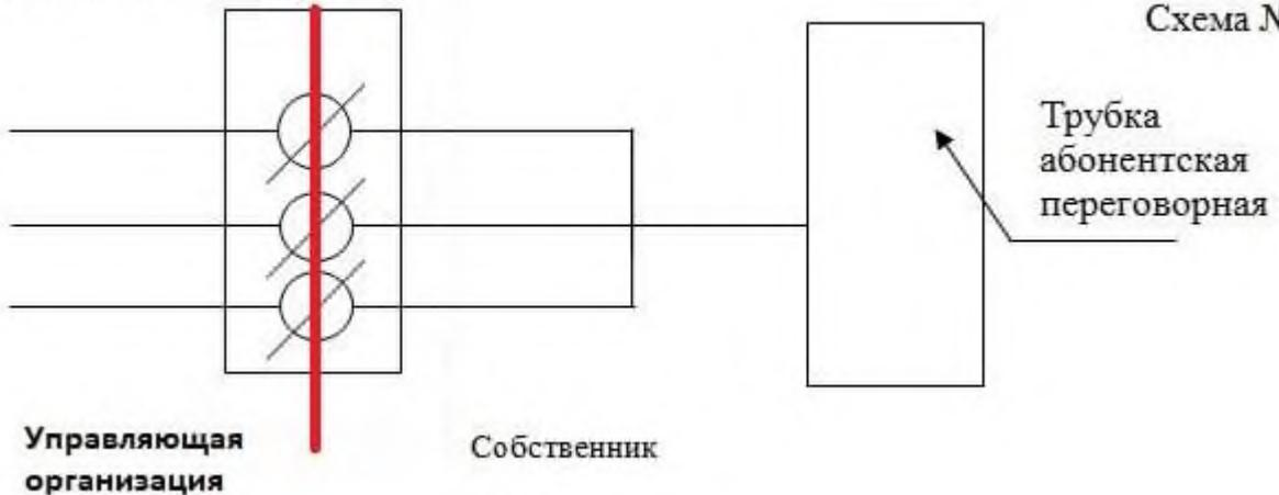
**5. Границей ответственности по системе автоматизированного водоучёта ГВС, ХВС является клеммное соединение в соединительной коробке, расположенной в коммуникационной шахте санузла.**
